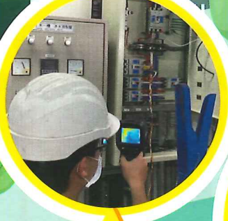
電力盤熱點量測
